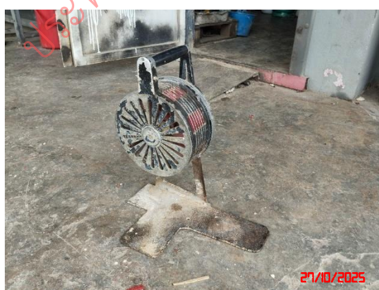
รูปที่ 15 เครื่องส่งสัญญาณเสียงเตือนการระเบิด
